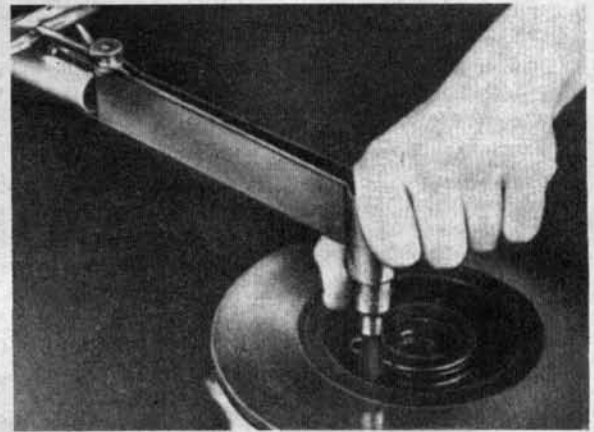
Рис. 4.3.6. Затяжка болтов крепления тормозного диска к ступице переднего колеса
