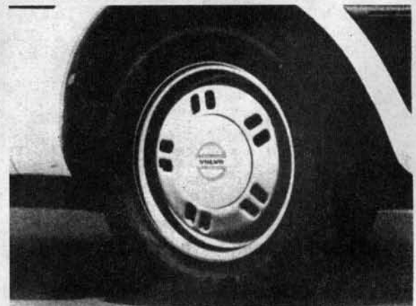
Рис. 4.3.7. Новый тип стальных колесных дисков, применяемый с 1986 г. и рассчитанный на модифицированные тормозные диски и тормозные щитки
