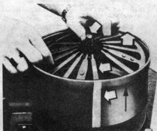
Рис. 3.4.26. Снятие тарельчатых пружин шкивов входного уровня коробки CVT
