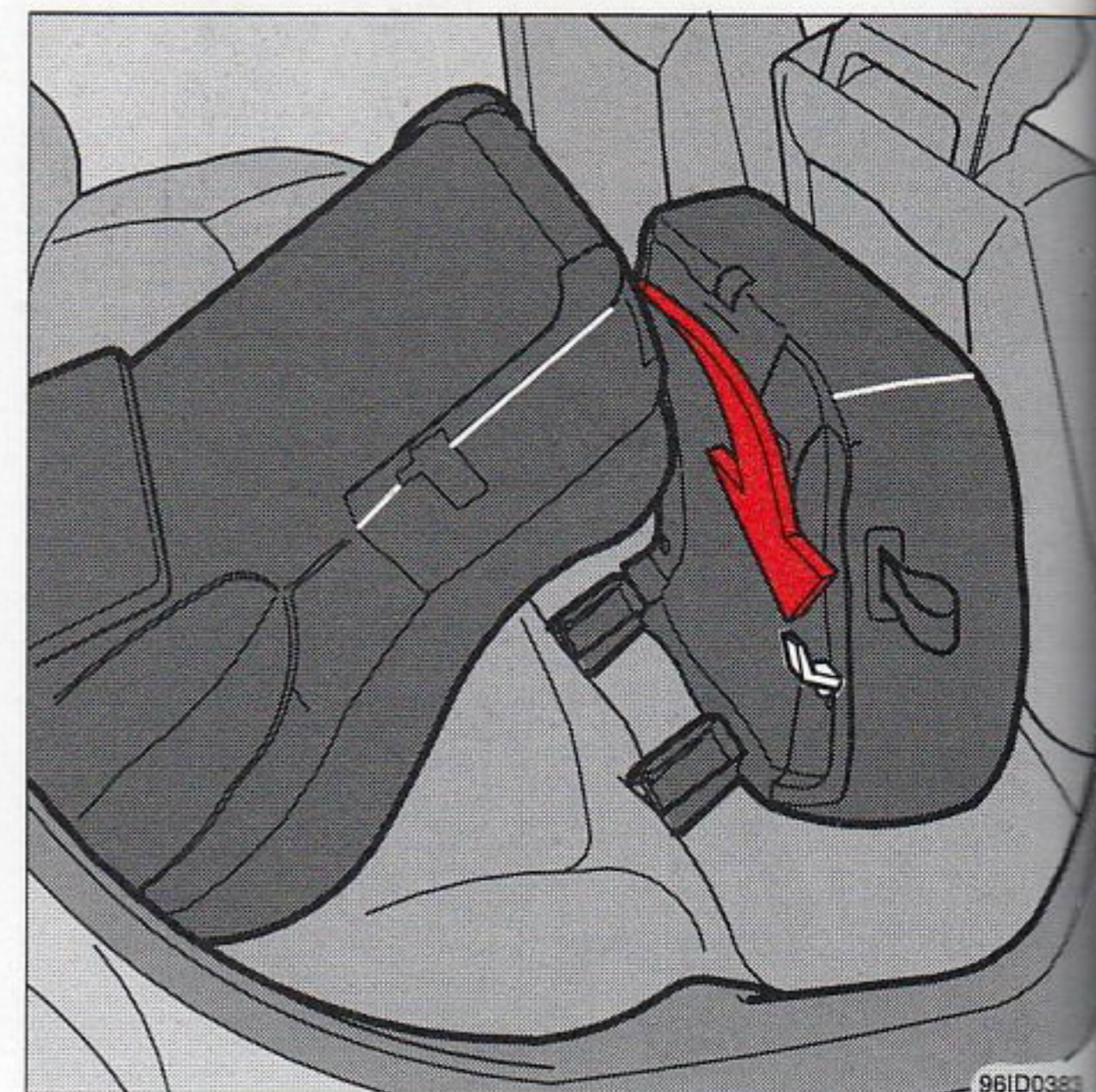
Выступы входят в отверстия
