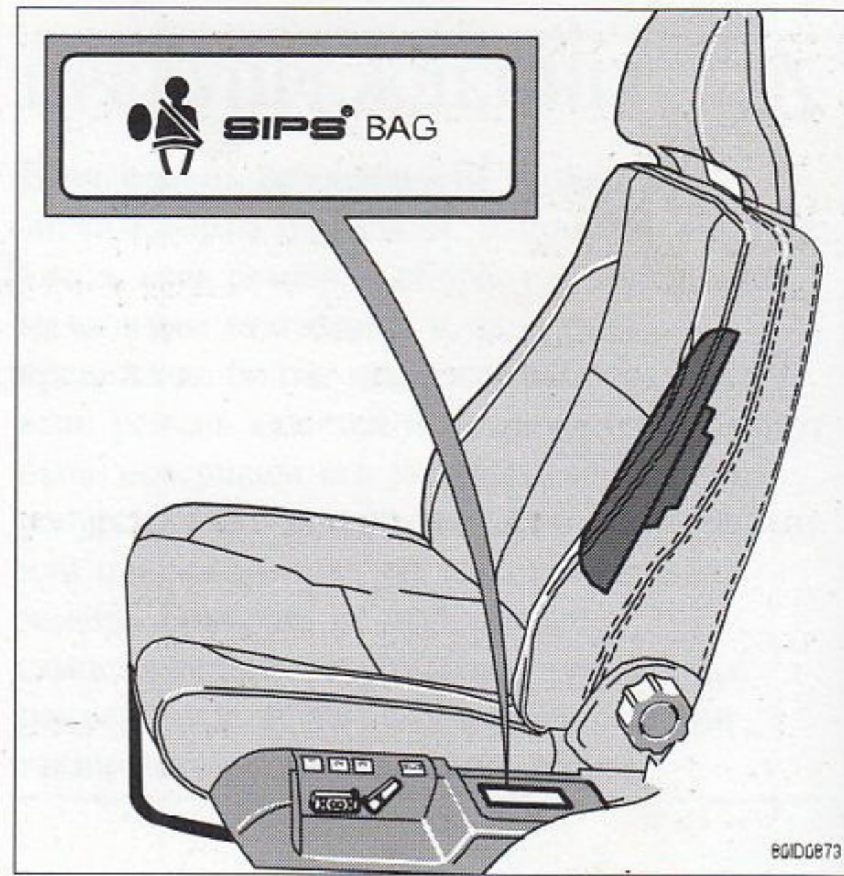
Боковые противоударные надувные мешки располагаются в спинках сидений водителя и пассажира
